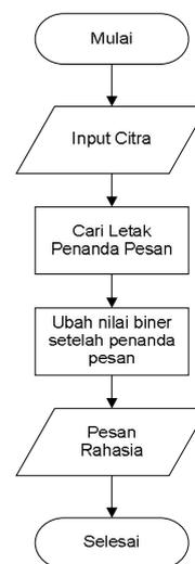
Gambar 2.3 Diagram alir proses pengungkapan pesan metode EOF
