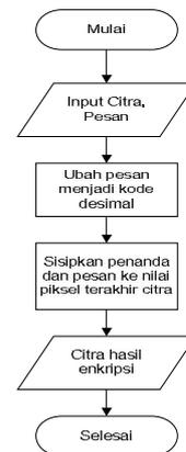
Gambar 2.2 Diagram alir proses penyisipan pesan metode EOF
