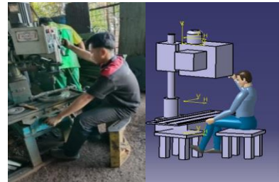
Gambar 4.3 Postur Kerja Existing dan Sesudah Perbaikan Mesin Bor Milling 1
