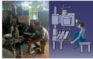
Gambar 4.2 Postur Kerja Existing dan Sesudah Perbaikan Mesin Bubut 2
