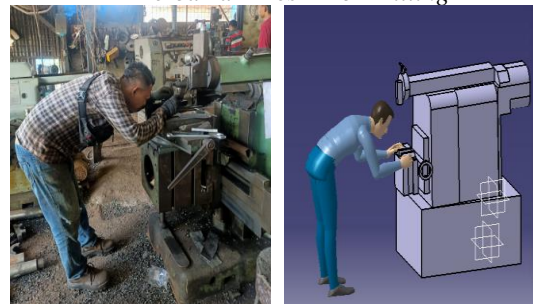
Gambar 4.4 Postur Kerja Existing dan Sesudah Perbaikan Mesin Bor Milling 2
