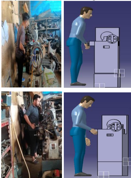
Gambar 4.1 Postur Kerja Existing dan Sesudah Perbaikan Mesin Bubut 1
