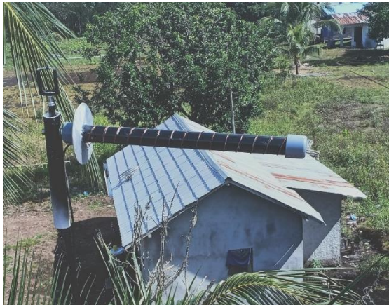
Gambar 2 Antena Helix Yang Telah Dirancang
