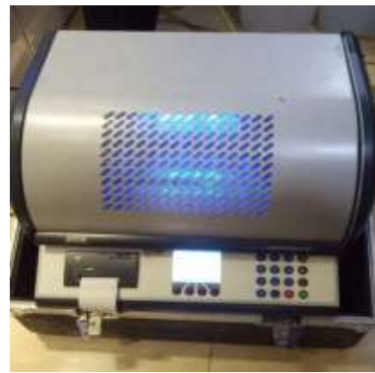
Gambar 5. Alat uji tegangan tembus (BAUR DTA 100 C)
