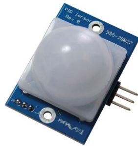
Gambar 7. Bentuk fisik sensor PIR
