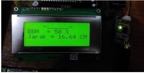
Gambar 14 Pengujian rangkaian sensor ultrasonik
