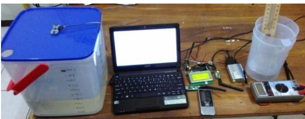
Gambar 16 Pengujian perancangan sistem monitoring penggunaan bahan bakar minyak (BBM) dan temperatur.
