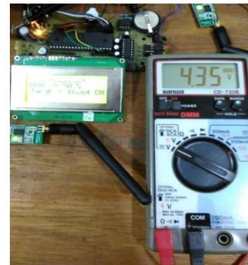
Gambar 12 Skema pengujian rangkaian catu daya
