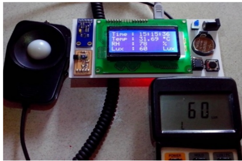
Gambar 9. Pengujian sensor BH1750FVI
