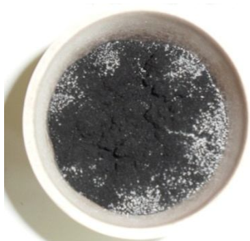
Gambar 2. Hasil aktivasi arang tempurung kelapa
