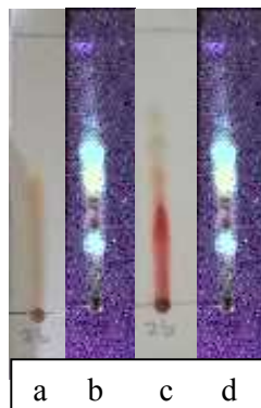
Gambar 1. Profil KLT senyawa S2 dengan eluen kloroform:etil asetat (3,5:6,5), (a) penampakan visual sebelum diemprot dengan FeCl 3 1 %, (b) penampakan pada UV \lambda 366 nm sebelum disemprot dengan FeCl 3 1 %, (c) penampakan visual setelah disemprot dengan FeCl 3 1 %, (d) penampakan pada UV \lambda 366 nm sesudah disemprot dengan FeCl 3 1 %
