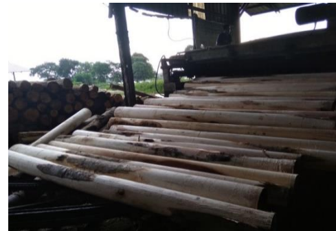
Gambar 1. Log yang sudah dikupas kulit dengan menggunakan mesin pengupas log ( log debarker ).
