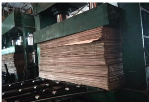
Gambar 7b. Proses hot press dilakukan selama \pm 7 menit dengan tekanan yang digunakan yaitu 50 \text{ kg/cm}^2 .
