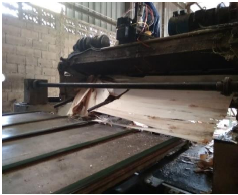
Gambar 2. proses pengupasan log dengan rotary dan menghasilkan lembaran veneer
