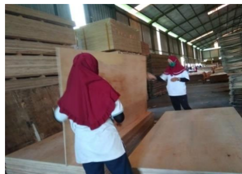
Gambar 8. Penyeleksian plywood dengan memeriksa seluruh permukaan dan isi plywood dari cacat atau kerusakan serta menentukan grade kualitasnya.
