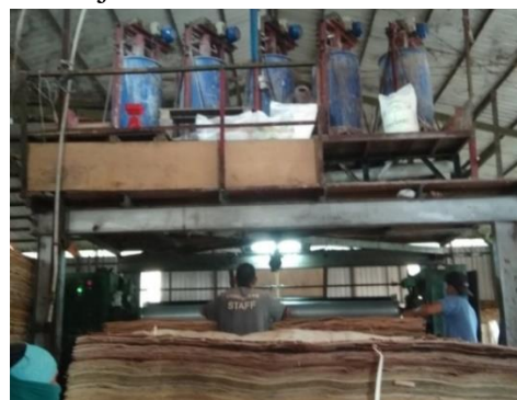
Gambar 6. Proses pengeleman, core veneer dilaburi perekat menggunakan mesin glue spreader .
