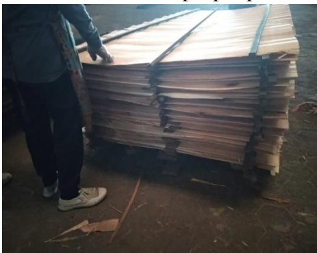
Gambar 3. Proses penyusunan veneer basah yang ditumpuk dan diselingi dengan stick agar mempercepat pengeringan.
