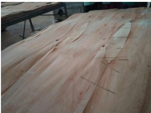
Gambar 5. Reparasi veneer yang diganti dengan veneer yang berbentuk daun dan merapikan veneer yang pecah dengan realing tape .
