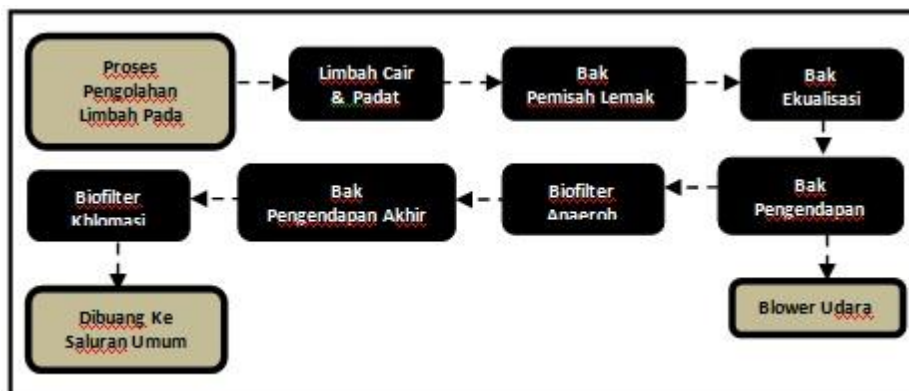
Gambar 24: Skema air kotor Restoran Melayu Pontianak
