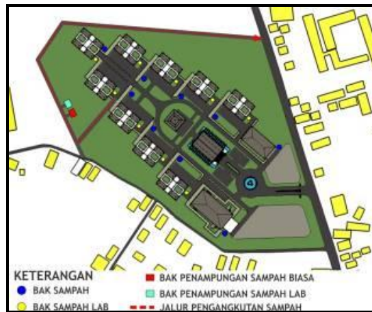
Gambar 20: Skema Persampahan Pada Perancangan Kawasan Politeknik Kapuas Hulu
