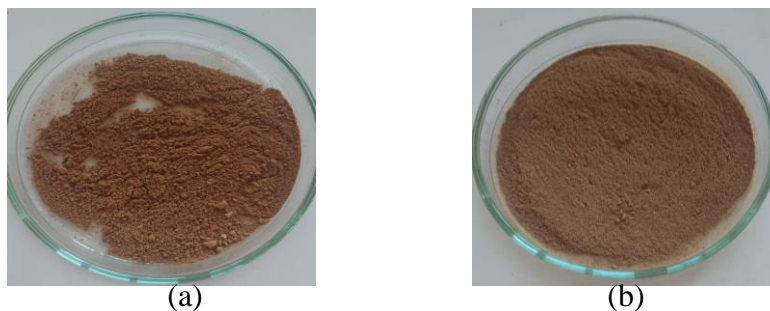
Gambar 1. Enkapsulat A dengan perbandingan (ekstrak kasar metanol:kitosan) 2:1 (a) dan enkapsulat B dengan perbandingan (fraksi metanol:kitosan) 1:2 (b)
