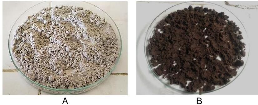
Gambar 2. Penampakan fisik pasir kuarsa sebelum terlapis  $\text{MnO}_2$  (a) dan pasir kuarsa setelah terlapis  $\text{MnO}_2$  (b)
