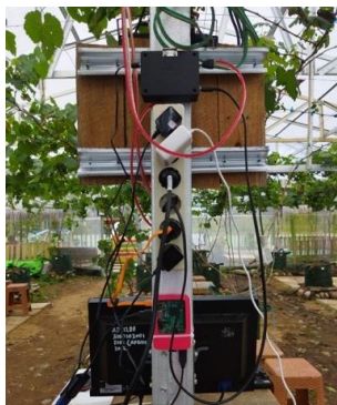
Gambar 9. Implementasi Sensor Suhu dan Kelembaban Udara
