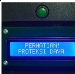
Gambar. 14 Tampilan proteksi daya pada LCD
