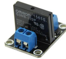
Gambar. 6 Modul SSR Omron G3 MB
