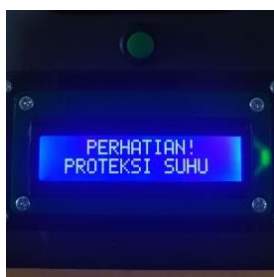
Gambar. 11 Indikator proteksi kenaikan suhu
