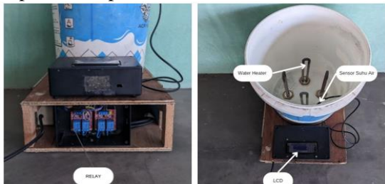
Gambar 8. Sistem Pemanas Air Mandi Otomatis
