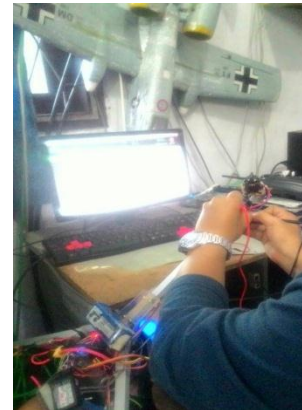
Gambar 16. Pengukuran Tegangan Pada Motor
