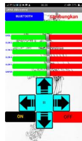
Gambar 6 Tampilan Interface Pengendali Robot Lengan 5 DOF Beroda
