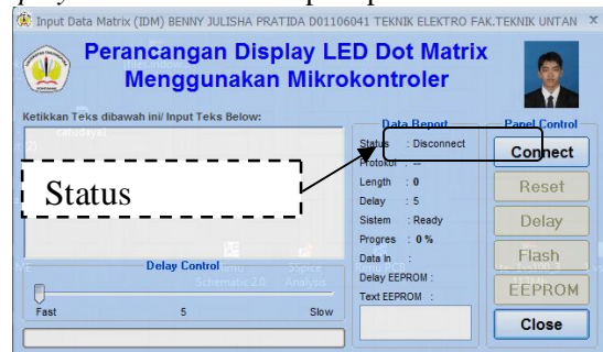
Gambar 3.2. Status Aplikasi dan Display LED Dot Matrix Belum Terhubung
