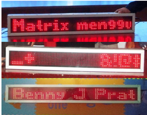
Gambar 3.7. Hasil pengujian aplikasi pengirim teks dengan Display LED Dot Matrix
