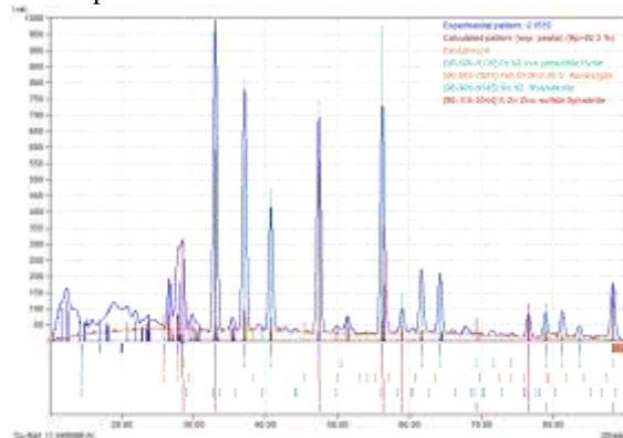
Gambar 4. Difraktogram XRD setelah diolah menggunakan Match! version 3.3 (Sumber : Hasil Analisis)
