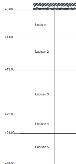
Gambar 3. Pemodelan Lapisan Tanah (Sumber: Hasil Perhitungan)
