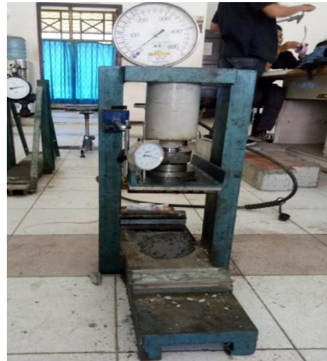
Gambar 4. Rangkaian alat uji kuat lentur ( Static Loading Frame, Hydraulic Manual Pump dan Dial Gauge )
