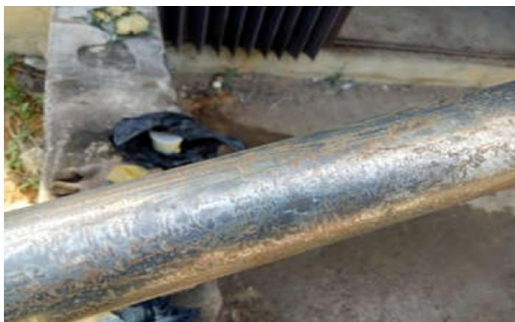
Gambar 10. Penampakan Visual Tiang Baja (Anoda) Setelah Perlakuan Elektrokinetik
