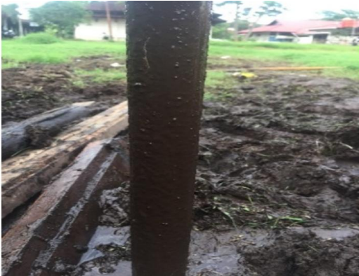
Gambar 8. Penampakan Visual Tanah di Sekitar Tiang Tunggal (Anoda) Setelah Perlakuan Elektrokinetik
