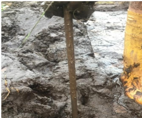
Gambar 9. Penampakan Visual Tanah di Sekitar Tulangan Baja (Katoda) Setelah Perlakuan Elektrokinetik
