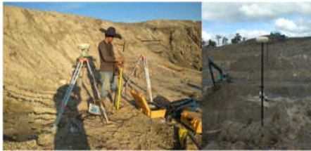
Gambar 6. Pemetaan Topografi dengan GPS Geodetik
