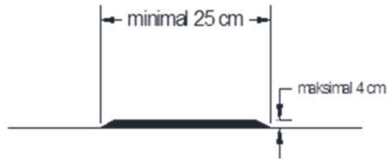
Gambar 1. Detil Pita Penggaduh (Surat Dirjen Perhubungan Darat No. AJ.003/5/9/DRJD/2011)
