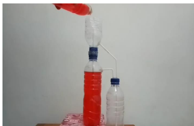
Gambar 4. Hasil Produk Alat peraga Air Mancur Sederhana
