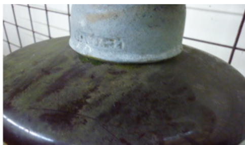
Gambar 1. Isolator berpolutan lumut
