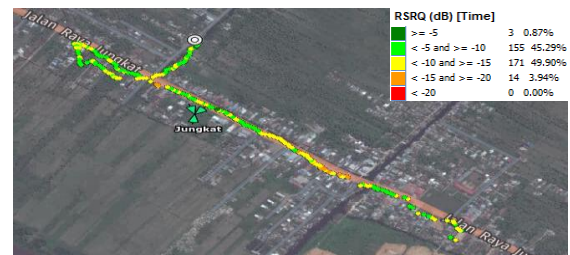
Gambar 5. Hasil Drive test Sebelum Perubahan Physical Tunning Antenna Sectoral untuk RSRQ
