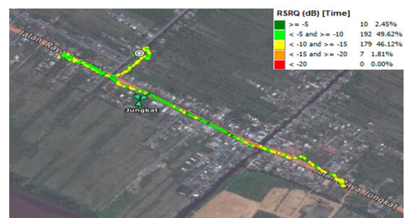
Gambar 6. Hasil Drive test Setelah Perubahan Physical Tunning Antenna Sectoral untuk RSRQ
