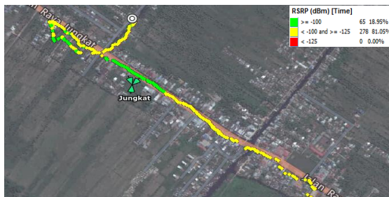
Gambar 3. Hasil Drive test Sebelum Perubahan Physical Tunning Antenna Sectoral untuk RSRP
