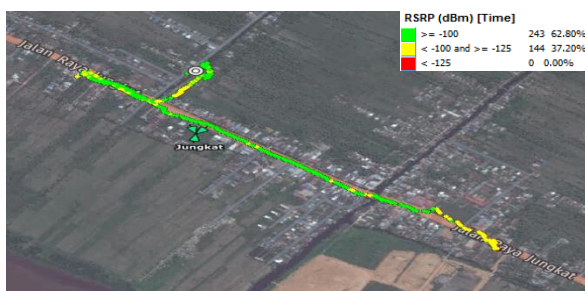
Gambar 4. Hasil Drive test Setelah Perubahan Physical Tunning Antenna Sectoral untuk RSRP
