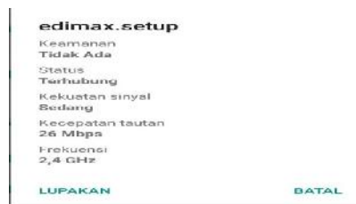
Gambar 16 Kekuatan pancaran sinyal pada jarak 47 m pada sudut 270°
