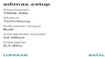
Gambar 12 Kekuatan pancaran sinyal pada jarak 65 m pada sudut 90°
