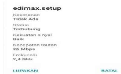
Gambar 14 Kekuatan pancaran sinyal pada jarak 65 m pada sudut 45°
