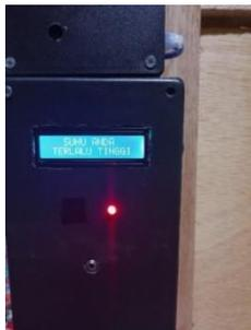
**Gambar 12** Tampilan pada alat yang ditampilkan ke LCD 16×2.
