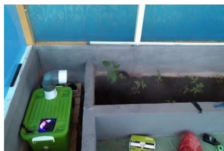
Gambar. 16 Kendali Kelembaban Udara Tanaman Menggunakan Mist Maker pada Smart Greenhouse
