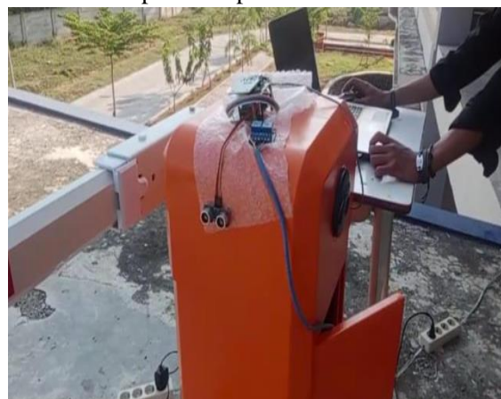
Gambar 16. Menghubungkan Mikrokontroler ESP32 dengan Barrier Gate
