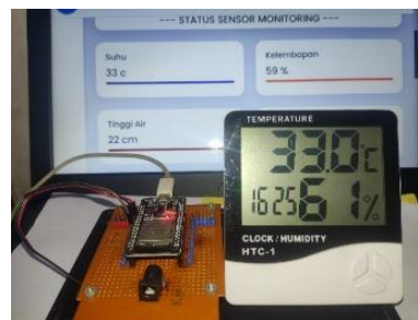
Gambar 24. Pengujian Suhu dan Kelembapan Udara
