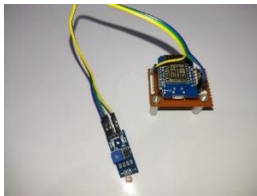
Gambar 18. Implementasi Sistem Pembacaan Intensitas Cahaya di Dalam Rumah Budi Daya Burung Walet
