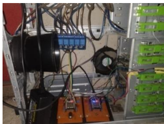
Gambar 13. Implementasi Sistem Pengontrolan di Dalam Rumah Budi Daya Burung Walet
