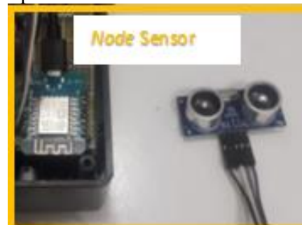
Gambar 17. Implementasi Komponen Node Sensor
