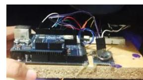
Gambar 13. Rangkaian Arduino, *Ethernet sheild*, dan modul RTC
