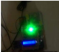
Gambar 14. Lampu LED Hijau Menyala Saat Mode SMS dan Suara Aktif
