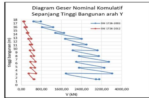
Gambar 10 Diagram Geser Nominal Kumulatif Sepanjang Tinggi Bangunan arah Y
