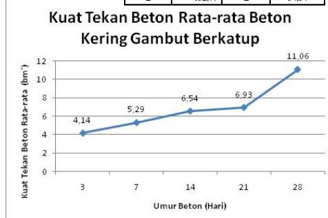
Gambar 2. Hasil Kuat Tekan rata-rata Beton Kering Gambut Berkatup
